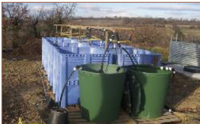
Les pilotes expérimentaux pour traiter du lactosérum par infiltration sur du compost végétal
